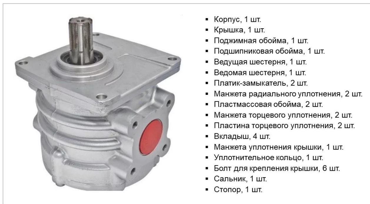
Рис. 1. Внешний вид и комплектация гидронасоса НШ100 А-3 (правый).
